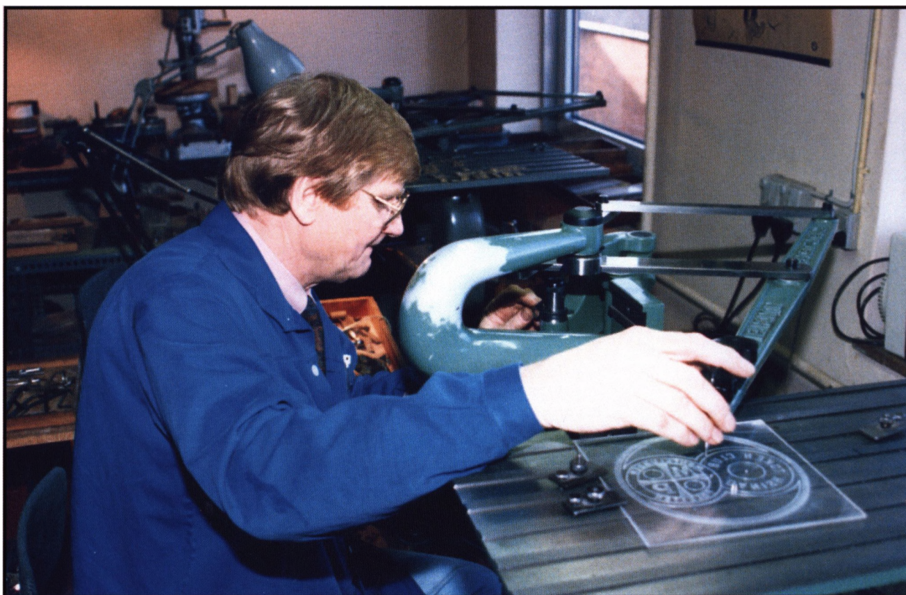
Med pantografen overfører Bent bogstaver og tal til stempel, på modellen af snurremøntens bagside, der viser bomærkerne fra Møntklubben Poletten og Danish Token Club.
