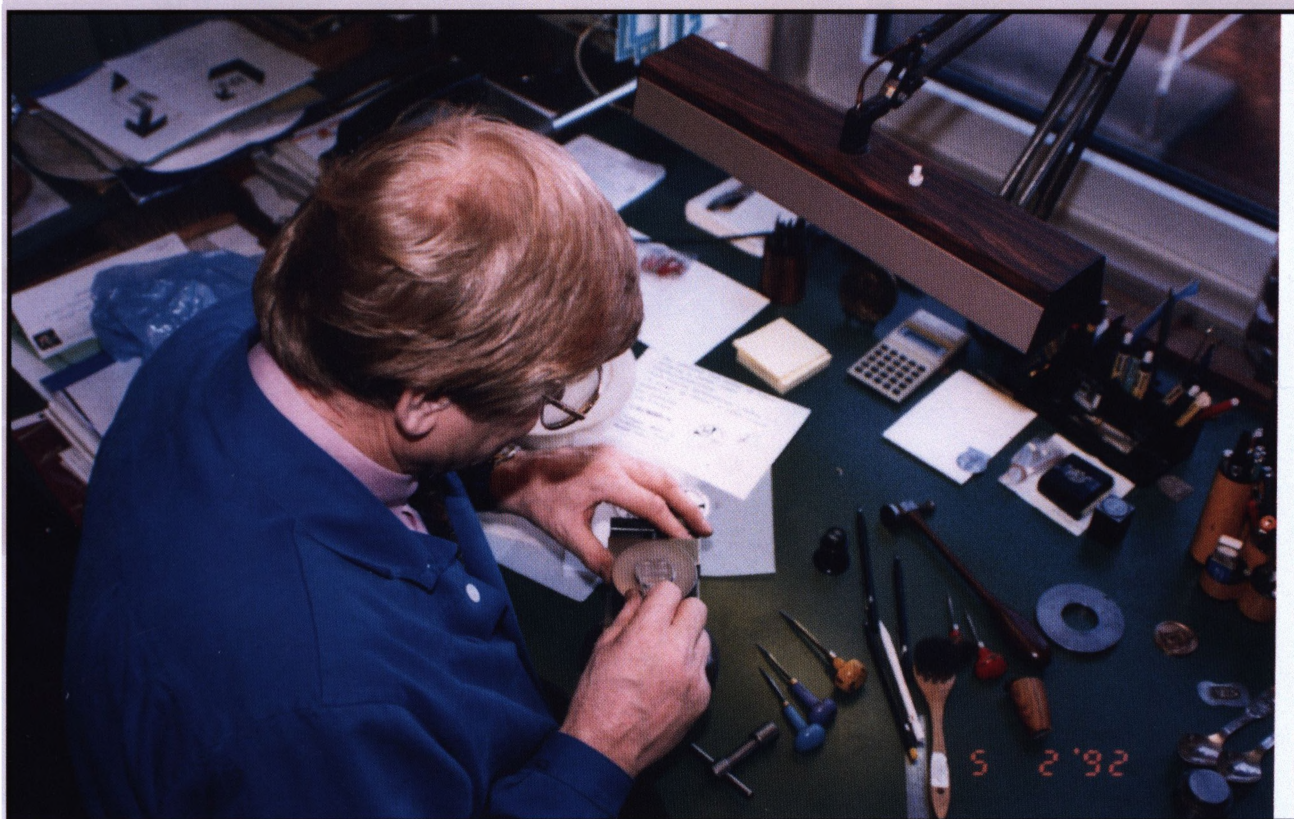
Bent er i gang med efterskæring og finpudsning af stempel. Det han bruger er en "stikkel". Ved hans højre hånd ligger 3 stikler.
